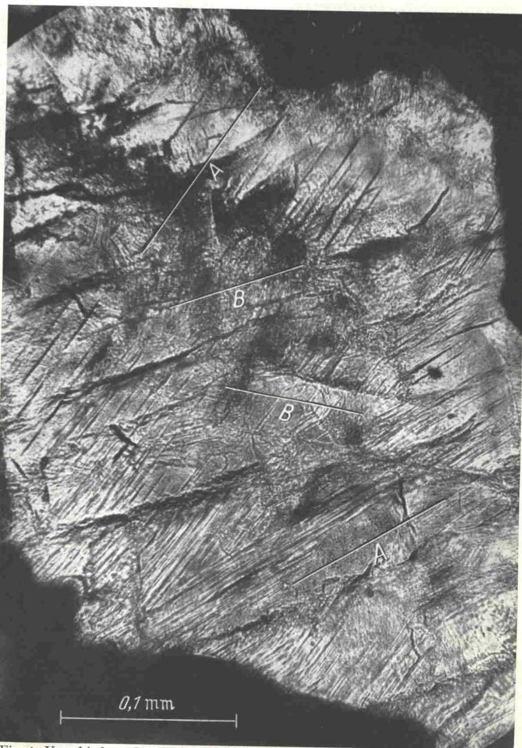
Fig. 1. Verschiedene Spaltflächensysteme in Quarz aus einem Graniteinschluß im Suevit von Zipplingen (Nördlinger Ries). A Fläche (10 $\bar{1}$ 3) oder (01 $\bar{1}$ 3); B Fläche (10 $\bar{1}$ 1) oder (01 $\bar{1}$ 1). Aufnahme in polarisiertem Licht; gekreuzte Nicols
